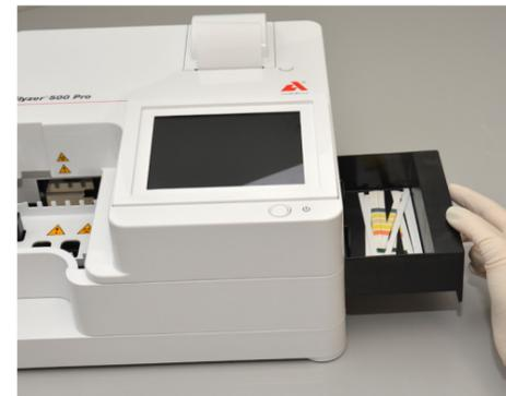
Abfallbehälter ausleeren, Analyzer reinigen
