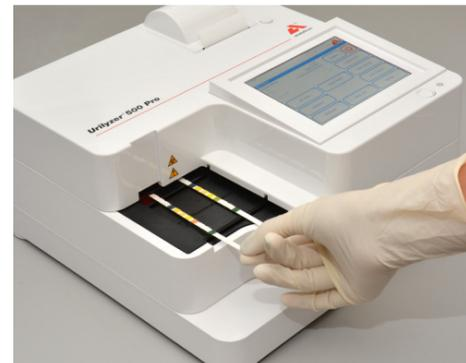
Urineststreifen auf den Teststreifenhalter legen, Messung startet
