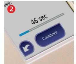
Im Normalmodus drücken Sie nach dem Eintauchen des Streifens innerhalb 5 Sekunden den Start Button (1). Ein Countdown erscheint (2) und die Messung beginnt automatisch nach 60 Sekunden (3).
